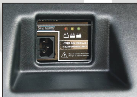
Встроенное высокочастотное зарядное устройство с индикатором заряда батареи и блокировкой вил
